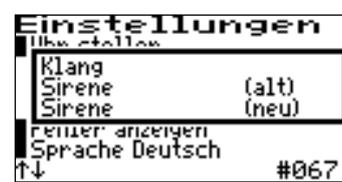
In diesem Menüpunkt kann die Alarmpause eingestellt werden. Zusätzlich kann der Alarm-Ton gewählt werden.
