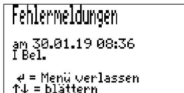
Mit den Pfeiltasten ▲ und ▼ kann im Logbuch geblättert werden. Mit der OK-Taste wird das Menü verlassen.
