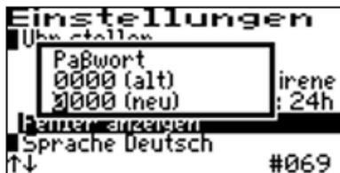
Mit den Pfeiltasten ▲ und ▼ wählen Sie die erste Zahl des Passwortes aus. Nach Betätigen der OK-Taste können Sie die zweite Zahl des Passwortes auswählen. Nach Betätigen der OK-Taste können Sie die dritte Zahl usw. (Modus gleich wie vorher beschrieben).
