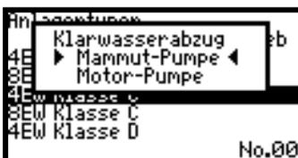
Anwahl des Klarwasserabzuges durch Mammut-Pumpe oder Motor-Pumpe durch die Pfeiltasten ▲ und ▼.
