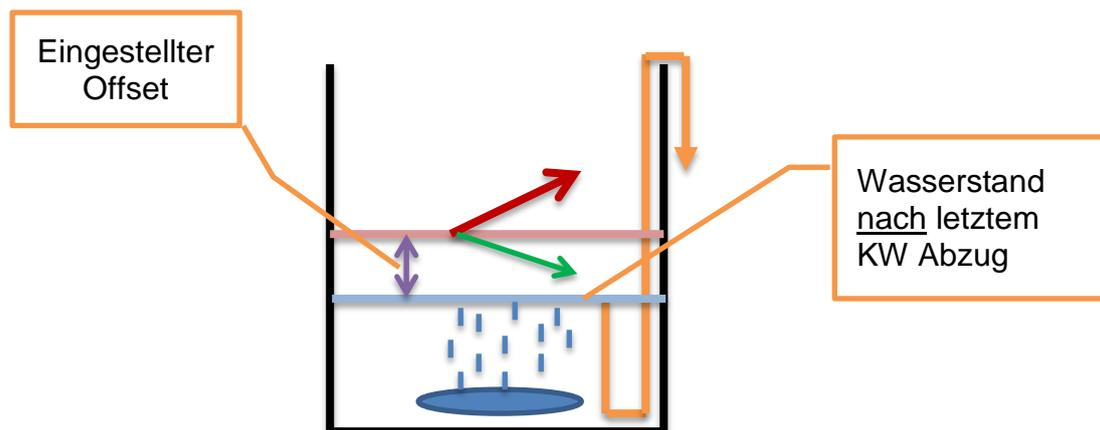
**Roter Pfeil** = Wasserstand höher als „zuletzt gemessener Wasserstand nach KW-Abzug + Offset 2“
