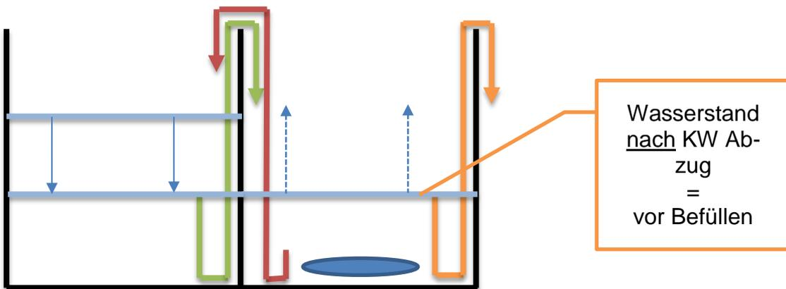
Es wird befüllt, der Wasserstand in der Vorklärung sinkt, der Wasserstand im Reaktor steigt.
