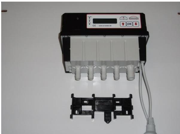
Um eventuell die Glassicherung bei einem Ausfall zu wechseln gehen Sie bitte wie folgt vor: Entfernen Sie die Steuerung von der Wandbefestigung. Auf der Unterseite der Steuerung (siehe hierzu Bild) befinden sich diverse Schrauben. Lösen Sie bitte nur die vier auf den Eckpunkten befindlichen mit einem Pfeil gekennzeichneten Schrauben.
