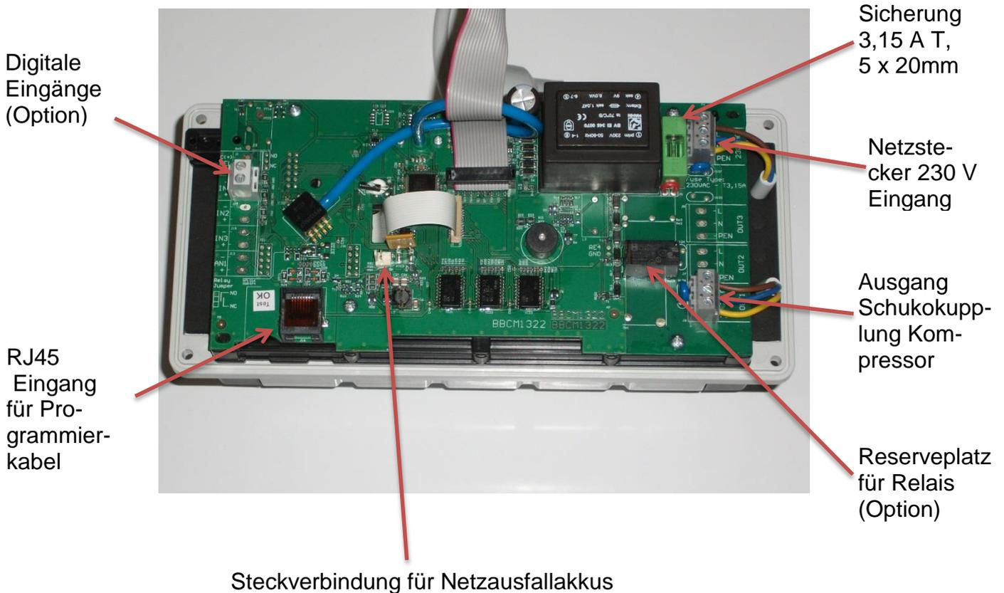
**Aktuwechsel:** **Achtung!** Bitte als Ersatz nur wieder aufladbare Akkus vom Typ AA verwenden. Normale Batterien würden zu einer Zerstörung der Steuerung führen. Die Akkus sind zugänglich über den Akkudeckel. Er muss aufgeschraubt werden (siehe hierzu Bild). **Unbedingt auf richtige Polarität der Akkus achten.**
